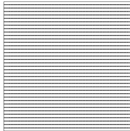
TEC-ACUSTIC 16 CARA VISTA Ranuras ancho 2,5 mm Paso 16 mm
