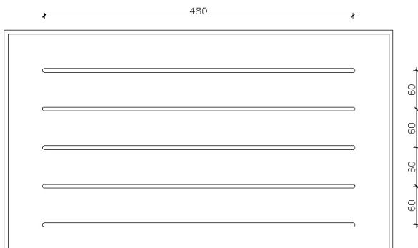
PLACA PERFORADA TIPO 3 \phi 8mm PASO 1: 60mm, PASO 2: 450mm APERTURA 9,2%
